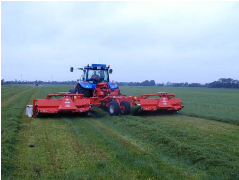
Figur 7.5 Skårlægning med tredobbelt skivehøster.
