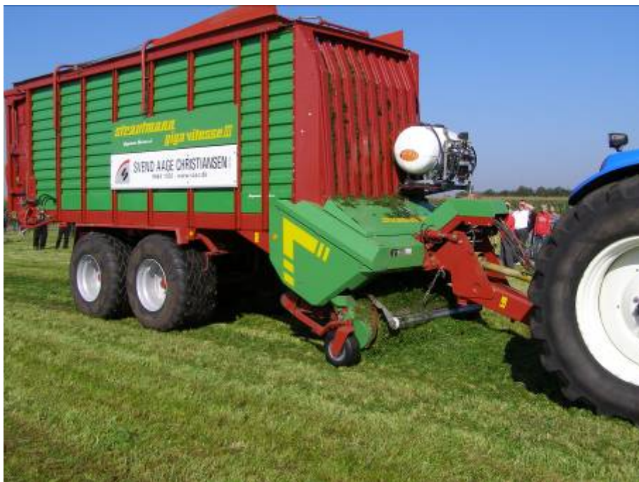
Figur 7.6 Opsamling af græs med selvlæssende vogn.
