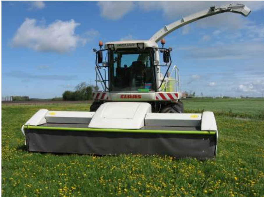
Figur 7.8 Finsnitter med skærebord.
