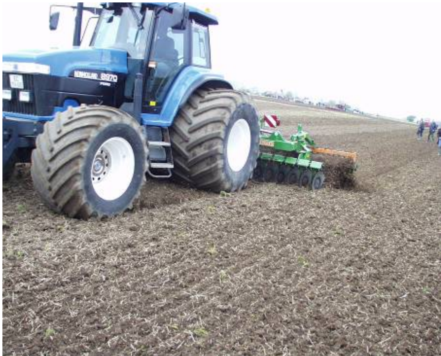
Figur 7.10 Traktor med brede terradæk.
