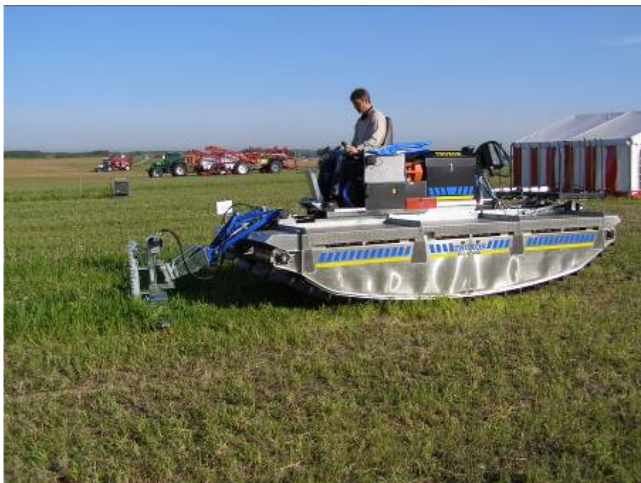
Figur 7.12 Bæltekøretøj med klippeanordning. Maskinen kan både sejle og køre på land.
