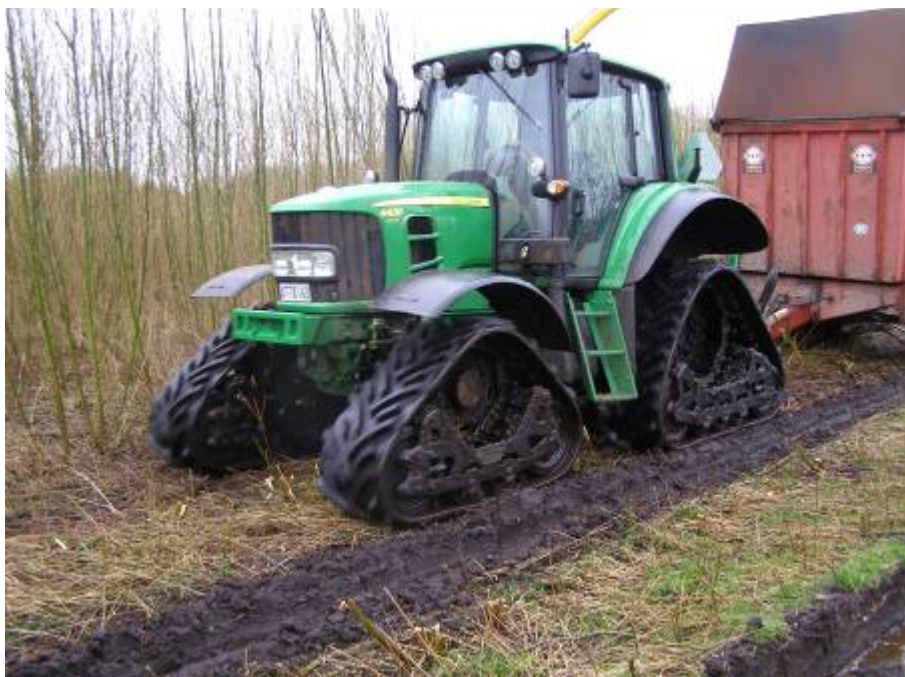
Figur 7.11 Traktor med halvbælter klarer sig fint på blød jord.
