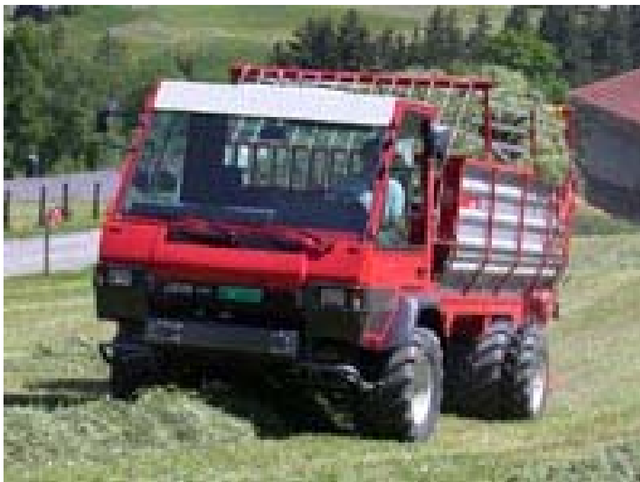
Figur 7.14 Selvkørende selvlæssende vogn.
