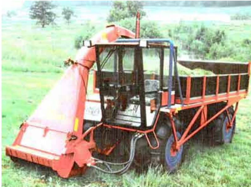
Figur 7.18 Hammel / Seiga med frontmonteret almindelig grønthøster.
