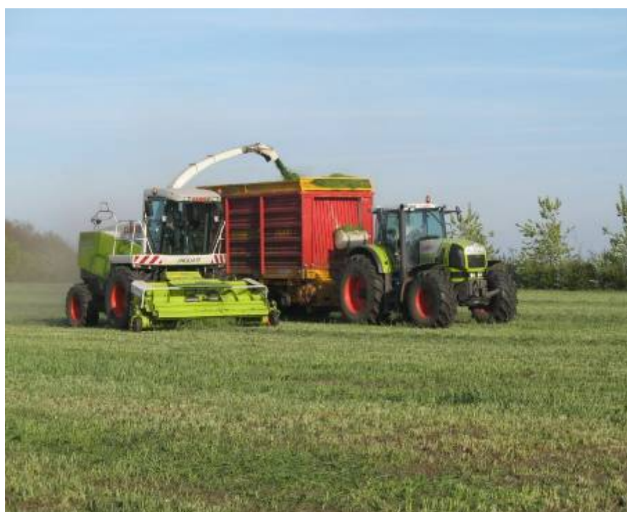
Figur 7.7 Finsnitter med pick-up.
