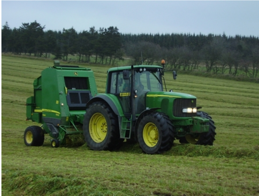
Figur 7.9 Opsamling af græs med rundballepresser.
