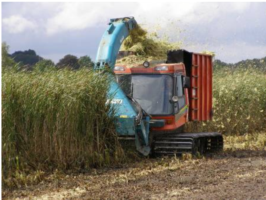
Figur 7.16 Bæltekøretøj med frontmonteret grønthøster og lad.
